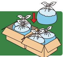
40リットル程度の容量のゴミ袋を二重にして、中に半分程度の水を入れて閉めます。これをダンボール箱に入れ、連結して使用します。
