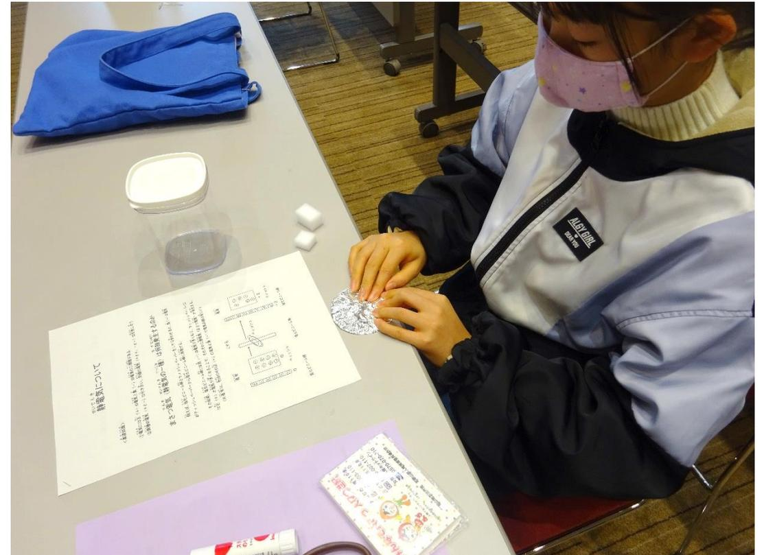
はく検電器を作ったよ。マイナス電気を帯電しているものを近づけると、容器の中のアルミ箔が動きます。ティッシュでこすったストローを近づけてみよう！
