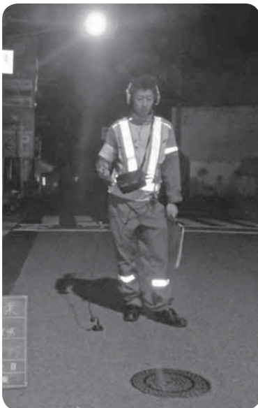
夜間漏水調査
