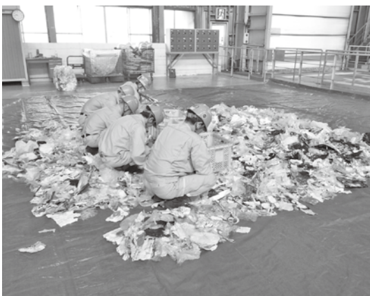
不適合物がないか詳しく検査します
