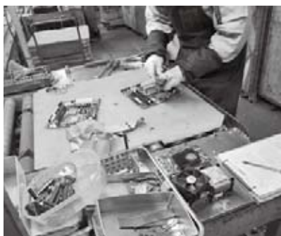
手作業によるパソコンの分解・分別の様子
