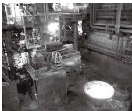
電気炉から取り出された溶鉄
