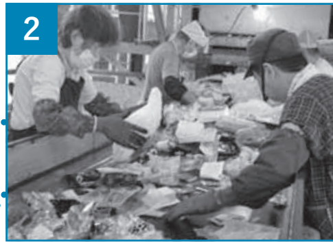
②破袋機 はたいき という袋を破く機械にかけ、その後手作業で分別を行います。 ※二重袋が入っていると、破くことができません。
