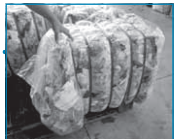
④圧縮梱包機 こんぼうき で40kg程度に圧縮梱包した出荷品「プラスチックペール」が出来上がります。
