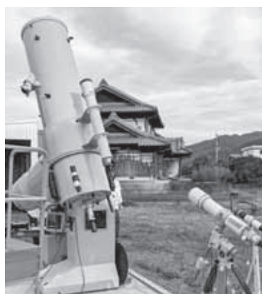
口径50cm反射望遠鏡（全長3m）
